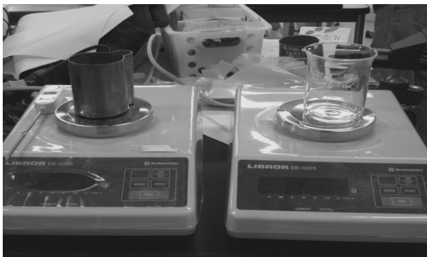
図7 実験の様子。左側が銅製の容器、右側が200[ml]ビーカーである。今回の実験では、どちらの容器も電子天秤の上に載せ、質量変化と同時に湯の温度も測定した。 Fig.7. The state of this experiment. The vessel on the left side is made by copper, on the right side is beaker. We put both vessel on the electron balance and measured the
