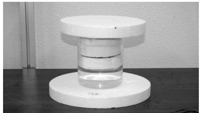
図4 上下を発泡スチロールの蓋をして密閉したビーカーの外観。上下の断熱と、ビーカー内部の空間の締め出しにより、気化の防止と系外への散逸を抑えることができる。
