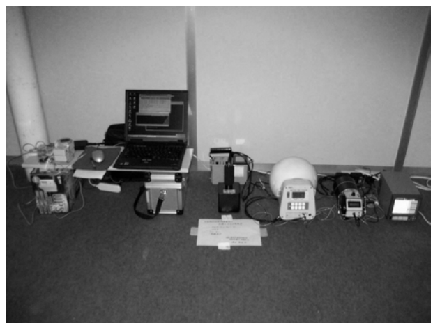
図 34 1号庁舎2階 (旧レーダードーム直下) の測定室 左半分がラジオ部のミュオン測定器、右は放医研の中性子測定器
