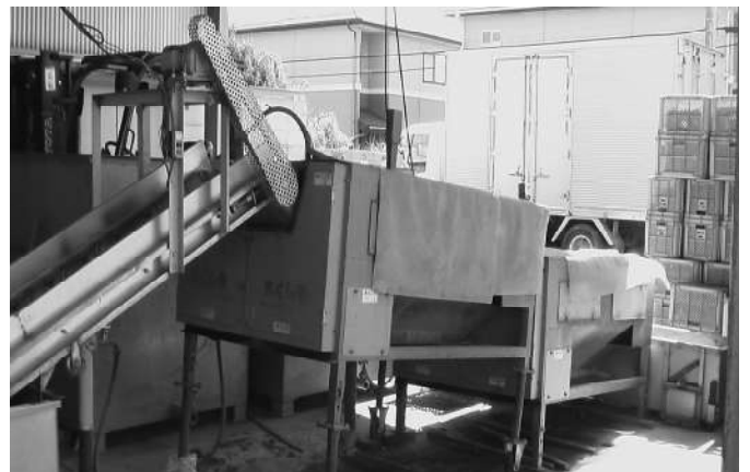
Fig.7 焼き芋用原料芋(ベニアズマ)の洗浄機
