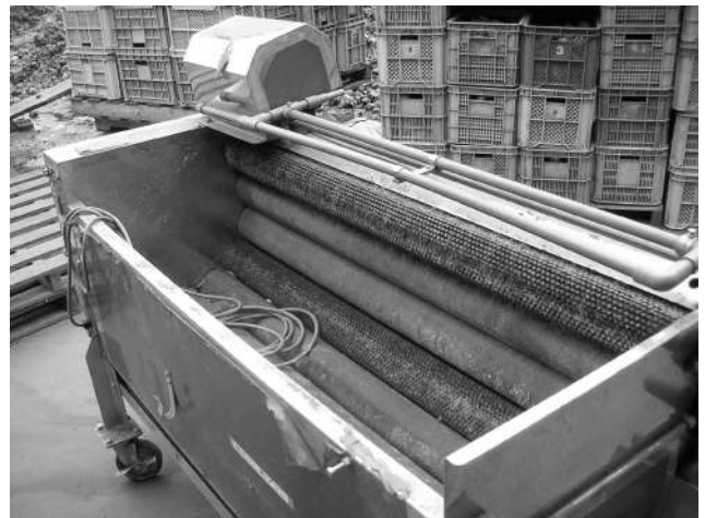
Fig.2 イワセ式根菜皮剥き機 型式 DUGSL-T150-8
