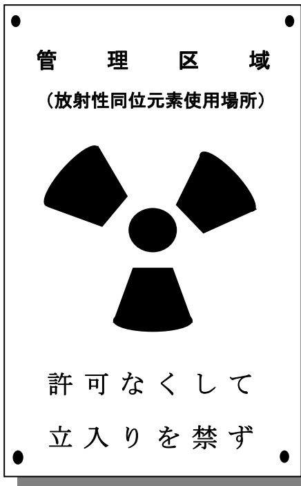
図5 管理区域（放射性同位元素使用場所）の標識
