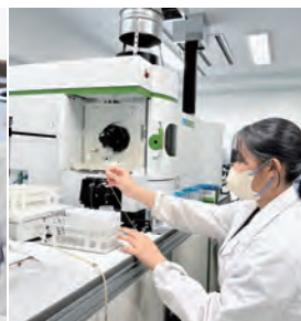
誘導結合プラズマ発光分析装置 (ICP-OES)
