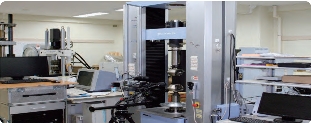
精密万能試験機オートグラフおよび三次元変形計測システムARAMIS (Precision Universal Tester AUTOGRAPH and Optical 3D Deformation Analysis ARAMIS)
